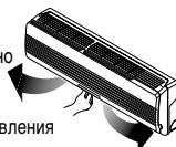
Настройка горизонтального направления потока воздуха производится вручную.
