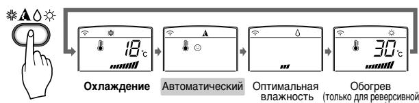
**3** Температура и скорость будут установлены автоматически в
