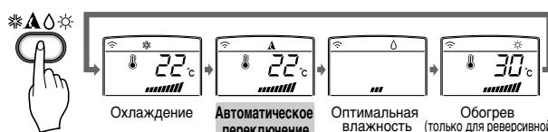
**3** Закройте крышку пульта ДУ. Установите температуру ниже комнатной. Можно установить температуру в диапазоне от 18°C до 30°C с шагом в 1°C.
